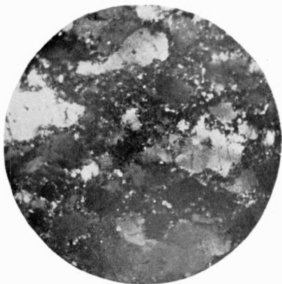
Structure porphyroclastique (Lum. pol. \times 37 ).
