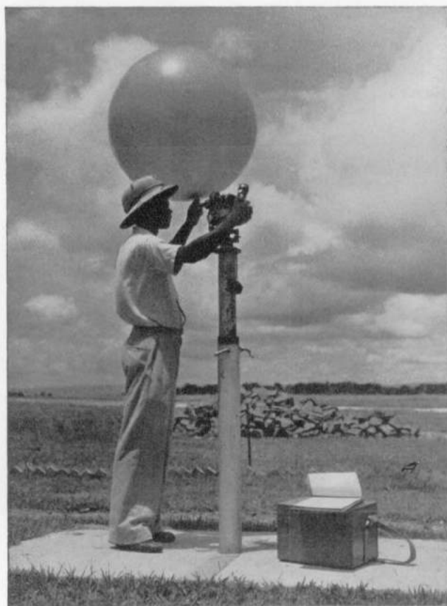
FIG. 2. — A l'aérodrome de Léopoldville, un observateur indigène préparant le lancement d'un ballon-sonde dont il suivra les évolutions au théodolite afin de déterminer la vitesse et la direction des vents à diverses altitudes et la hauteur du plafond de nuages. Photo C. LAMOTE.
