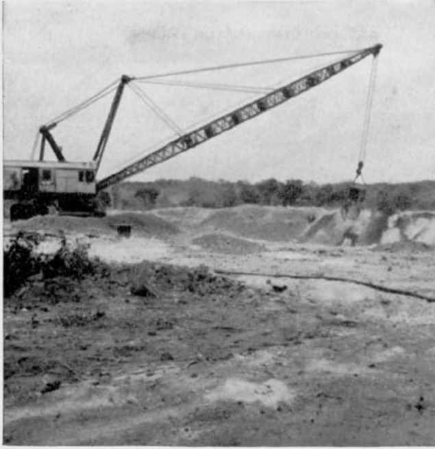
FIG. 1. — Charbonnages de la Luena. Enlèvement des morts-terrains par dragline à Kisulu.
