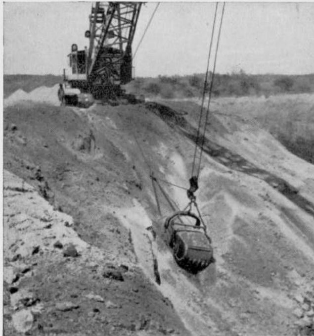
FIG. 2. — Charbonnages de la Luena. Enlèvement des morts-terrains par dragline à Kisulu.
