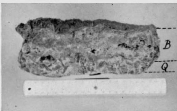
FIG. 11. — Remplissage d'un filon, entre épointes. Q : quartz, B : bastnaesite massive.
