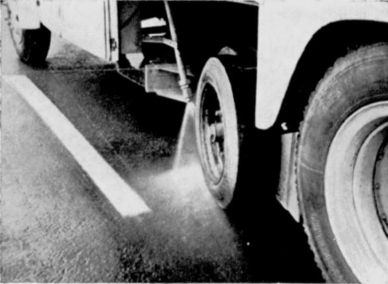
Fig. 2. Stradographe du Service d'étude et de contrôle de l'infrastructure des routes du Ministère des Travaux publics (Vue latérale inférieure).
