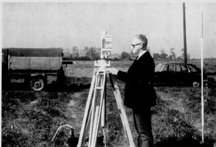
Fig. 4. — Mise en station (horizontalité du rayon).
