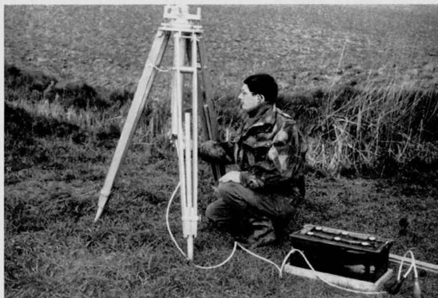
Fig. 3. — Connection de la batterie 12 V actionnant le laser et la rotation de rayon.
