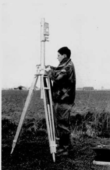
Fig. 2. — Mise à hauteur correcte de la colonne centrale.
