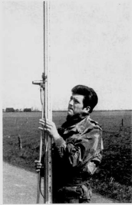
Fig. 8. — Déplacement de la tête chercheuse à l'aide de la tige de commande.
