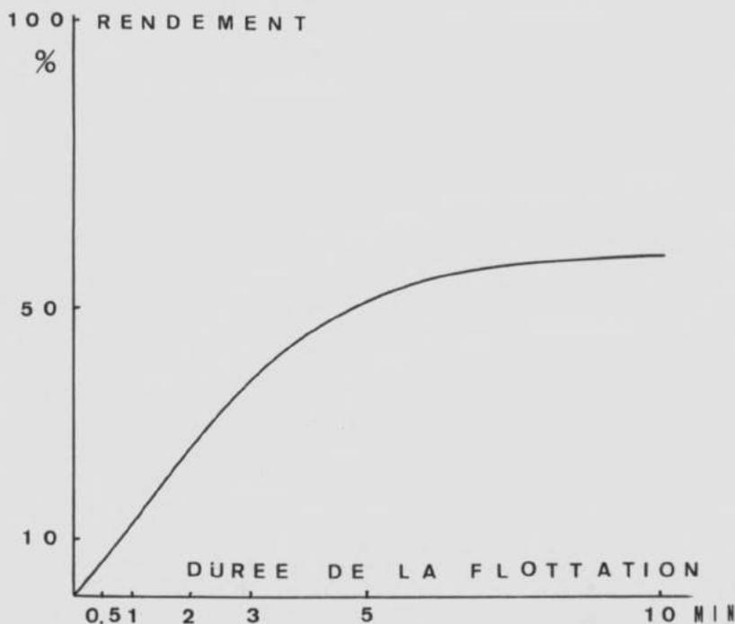
Fig. 1. — Rendement de la flottation en fonction de sa durée. Minerai: malachite 270-400 mailles; collecteur: acide stéarique à 1,76 micromoles par litre.
