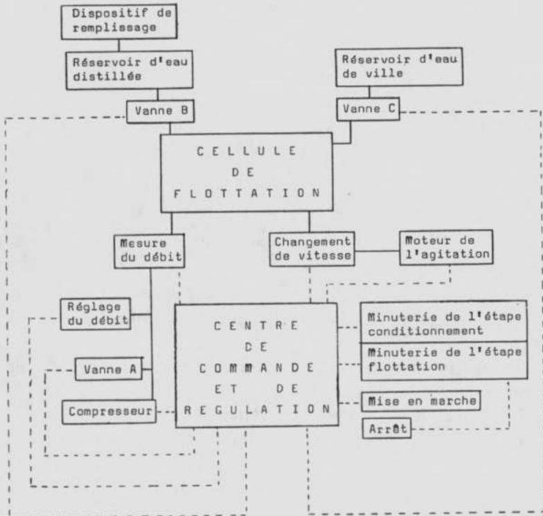
Fig. 1. — Schéma de la machine de flottation.
