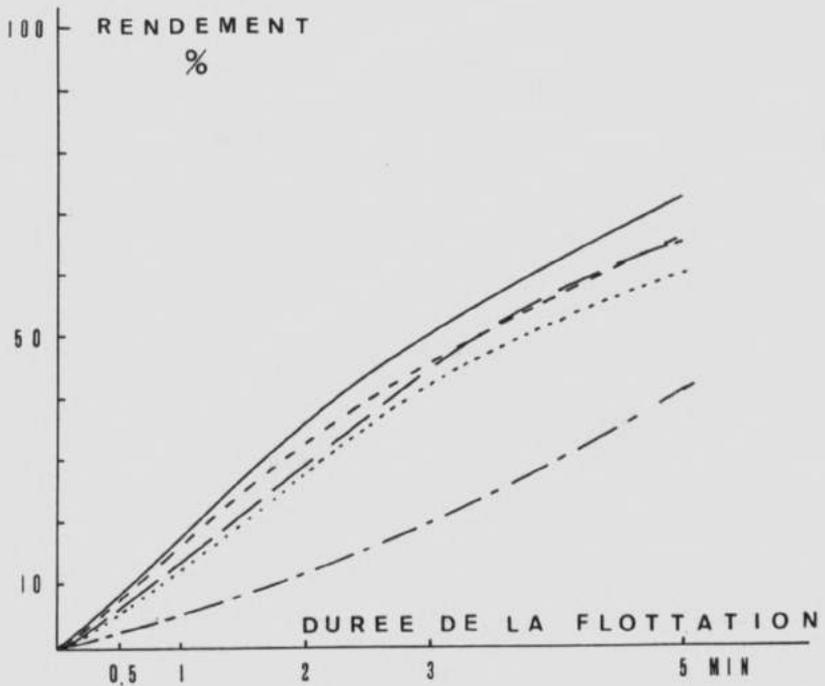
Fig. 3. — Influence du pH sur le rendement de la flottation du minerai de N'Sesa.
