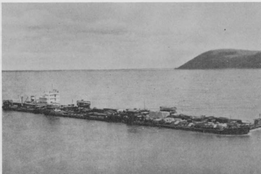
Fig. 3. — Remorqueur de 1000 CV poussant un convoi de 4500 t.
