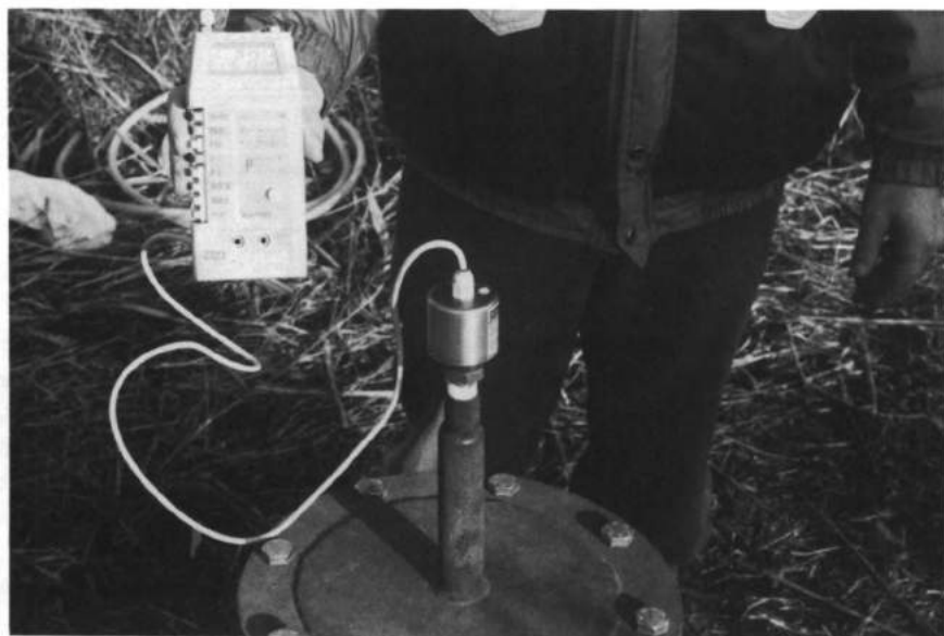
Fig. 2. — Meting van de onderdruk van 20 mbar die heerst op een diepte tussen 33 en 55 m onder maaiveld (+14 m) te Chin.
