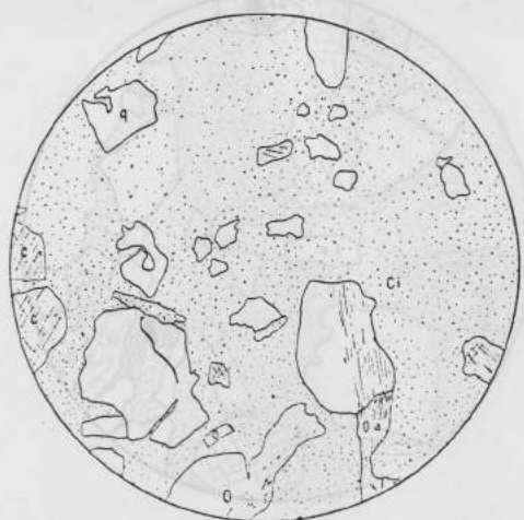
FIG. 9. — Conglomérat à ciment calcaireux vert de la Lubi. \times 30 . c.=calcite; ci.=ciment; q.=quartz; o.=orthose; o.a.=orthose altérée.
