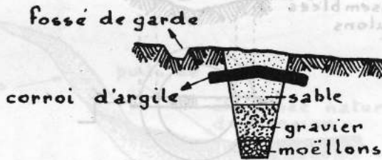
FIG. 15. — Coupe dans une galerie de captage.
