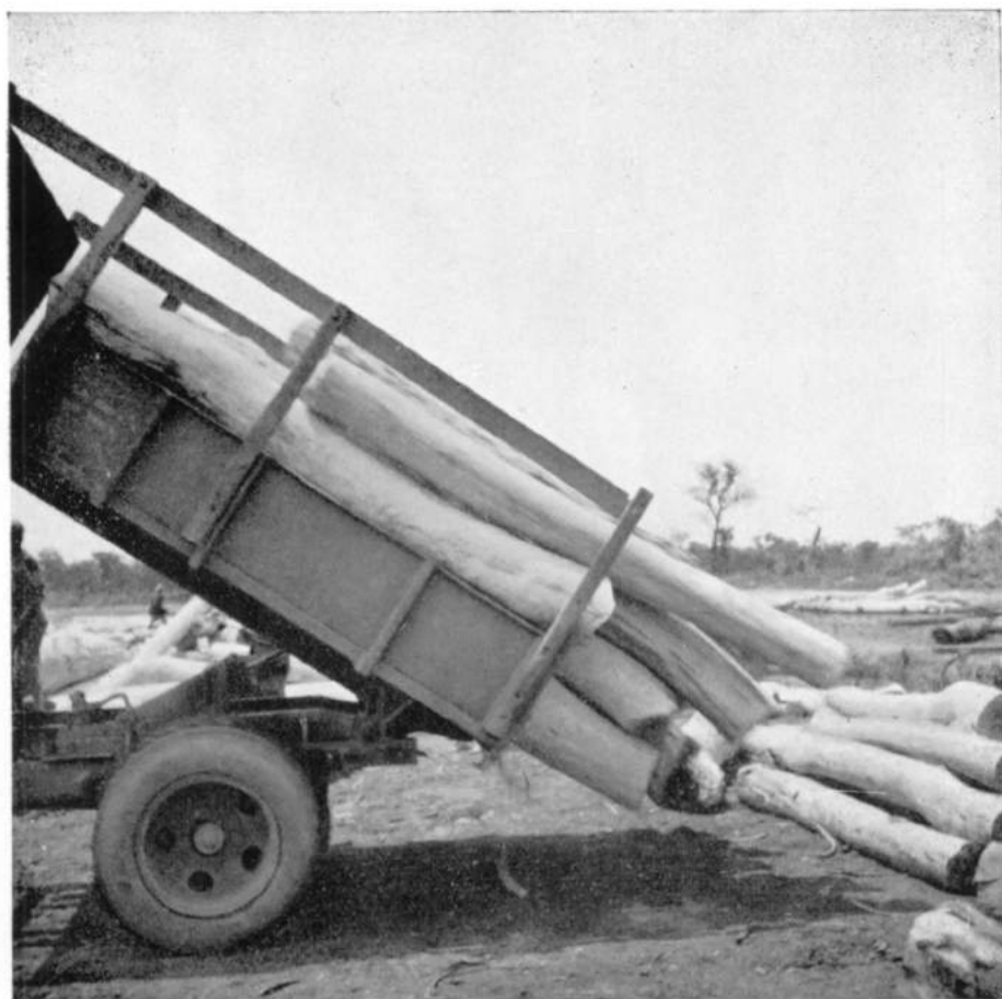
FIG. 5. — Déchargement par inclinaison du coffre du camion.
