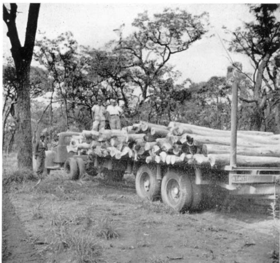
FIG. 13. — Essai de transport par remorque de 20 tonnes avec moteur auxiliaire actionnant les deux ponts arrières de la remorque.
