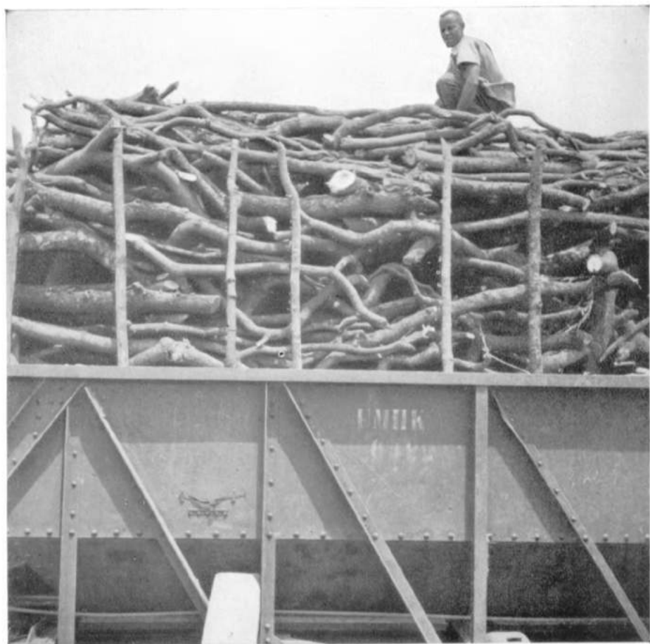
Fig. 10. — Wagon trémie chargé de bois de remplissage. On se rend compte que ce genre de bois tordu est impossible à charger mécaniquement.
