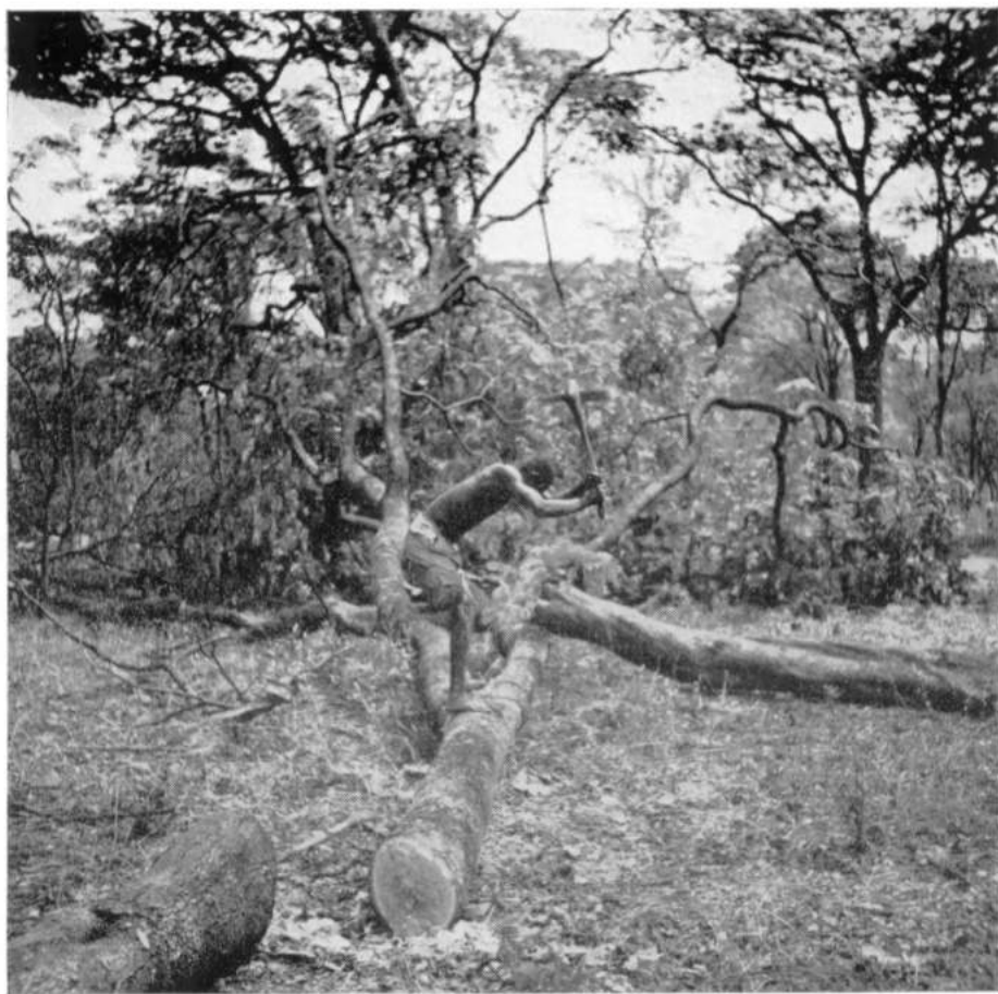
FIG. 2. — Débitage d'un tronç à la hache. On remarque sur cette photo la hache faite d'un bois noueux et d'un fer forgé hors d'une lame de ressort.
