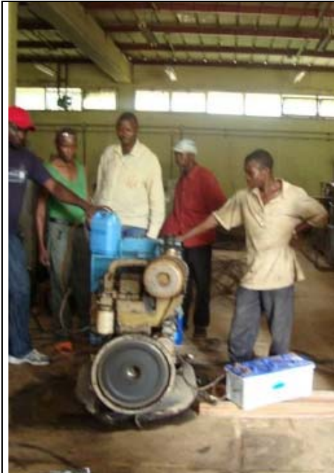
Essai de Petropalm par UNIKIN sur un générateur 50 KVA
