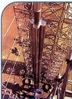
Le lanceur orbital privé sur son pas de tir. Ce prototype mesurait 15 mètres de haut et devait atteindre 100 kilomètres d'altitude. Hélas, ce fut l'échec.
